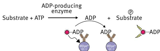
Fig. 2: Transcreener® ADP<sup>2</sup> FI Assay Principle
